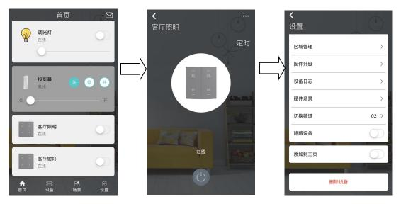
9. 若需要对轻触开关进行定时,点击轻触开关界面的"定时"键,进入定时设置,可设置多个定时任务。
