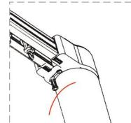
第三步：拔动拔头锁杆至右侧，直到杆头掉进右侧限位孔为止。
