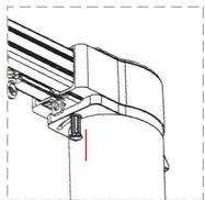
第一步：向下拉动拔头锁杆，使其顶端滑出限位孔。
