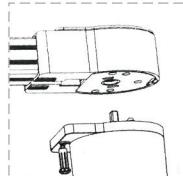
第一步：检查拔头锁杆是否在示意图位置，如果在图示右侧，请先拉动拔头锁杆的同时拔向左侧。
