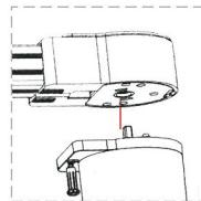
第三步：拔动拔头锁杆至右侧，直到杆头掉进右侧限位孔为止。
